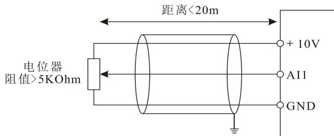
图 3-14 模拟量输入端子接线方式
