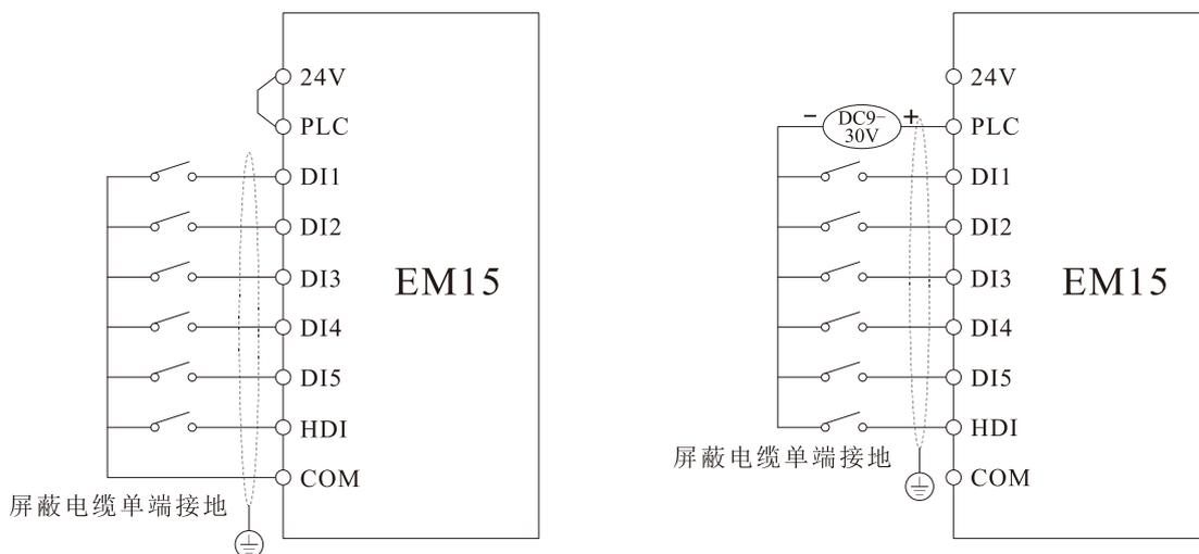
图 3-13 两种不同模式下数字输入端子接线图
