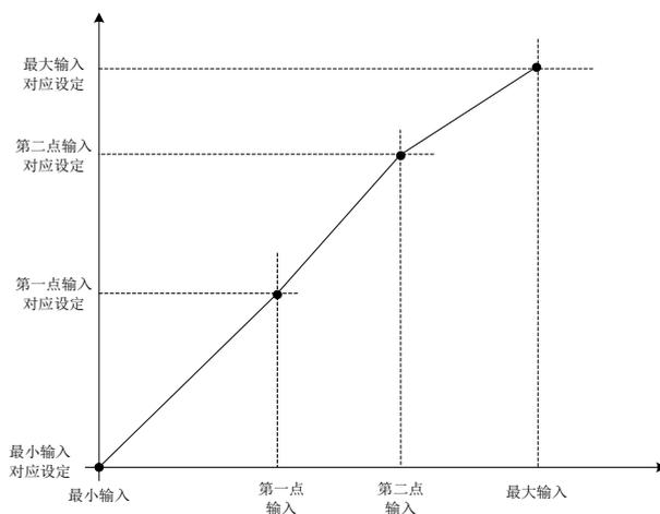
图 5-21 模拟量输入与设定关系
