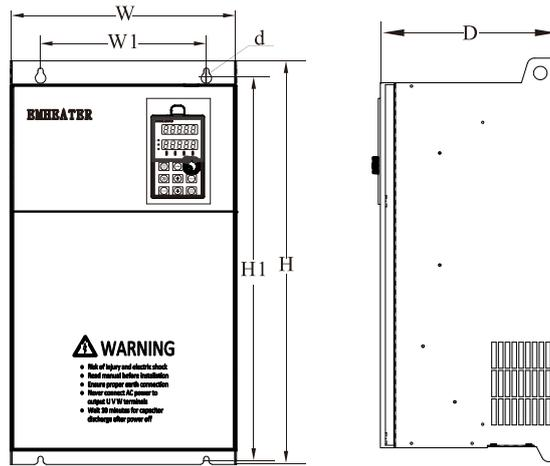
图 2-4 EM15 三相 30~500kW 壁挂安装尺寸图
