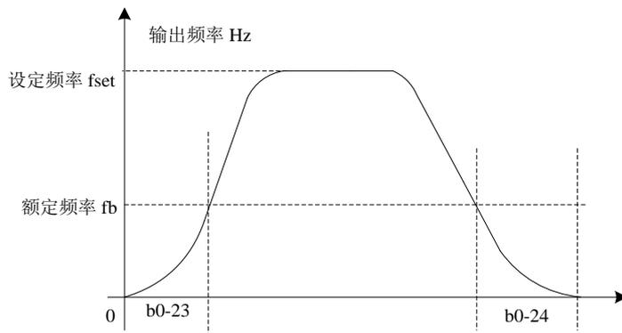
图 5-2 S 曲线加减速 B 示意图
