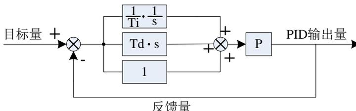
图 5-25 过程 PID 原理框图
