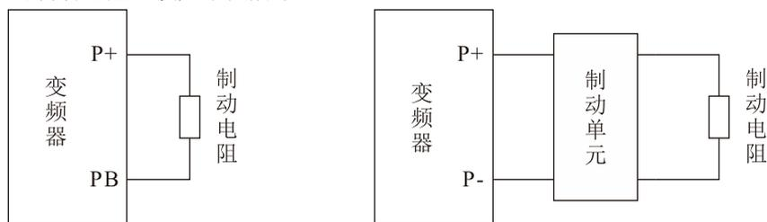
图 2-6 制动电阻连接示意图
