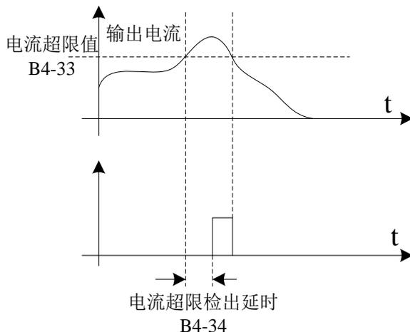
图 5-18 输出电流超限检测示意图
