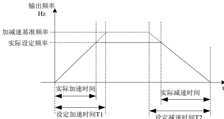
图 5-3 加减速时间示意图
