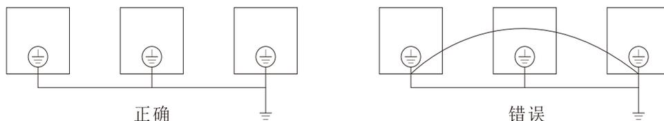
图 3-8 接地线接法示意图
