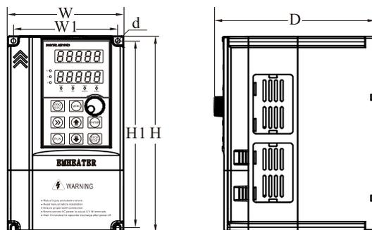
图 2-3 EM15 三相 4~22kW 壁挂安装尺寸图
