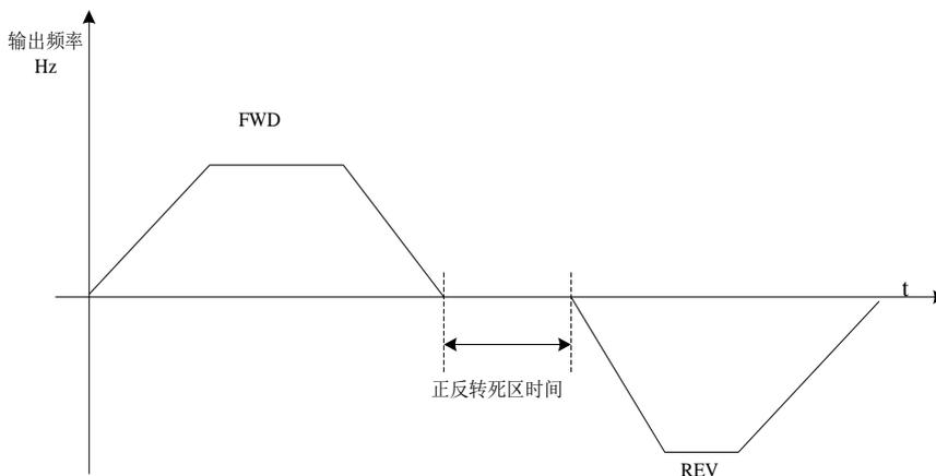
图 5-9 正反转死区时间示意图
