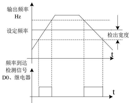
图 5-15 频率到达检出幅值示意图
