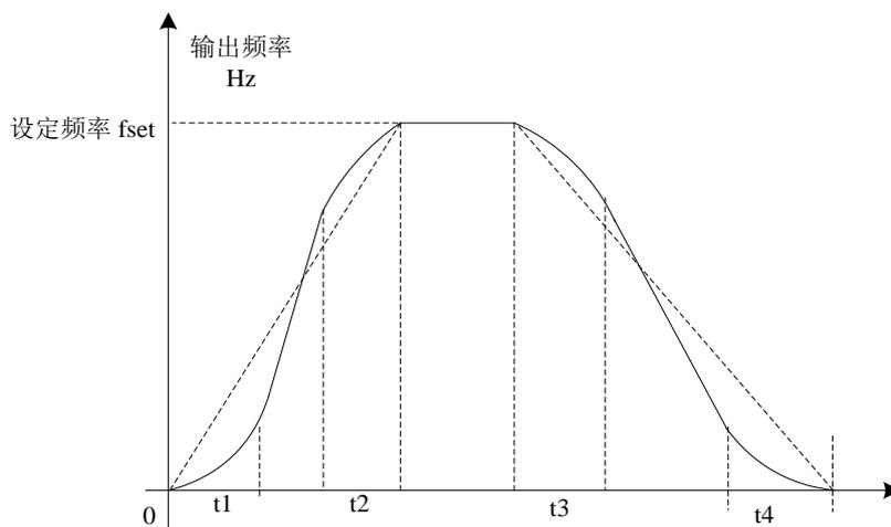
图 5-4 S 曲线加减速 A 示意图
