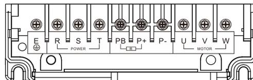
注意: P+和P-为直流输入, 禁止外接制动单元
