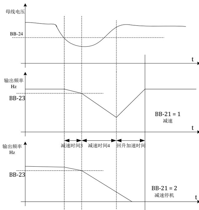
图 5-24 瞬时停电动作示意图
