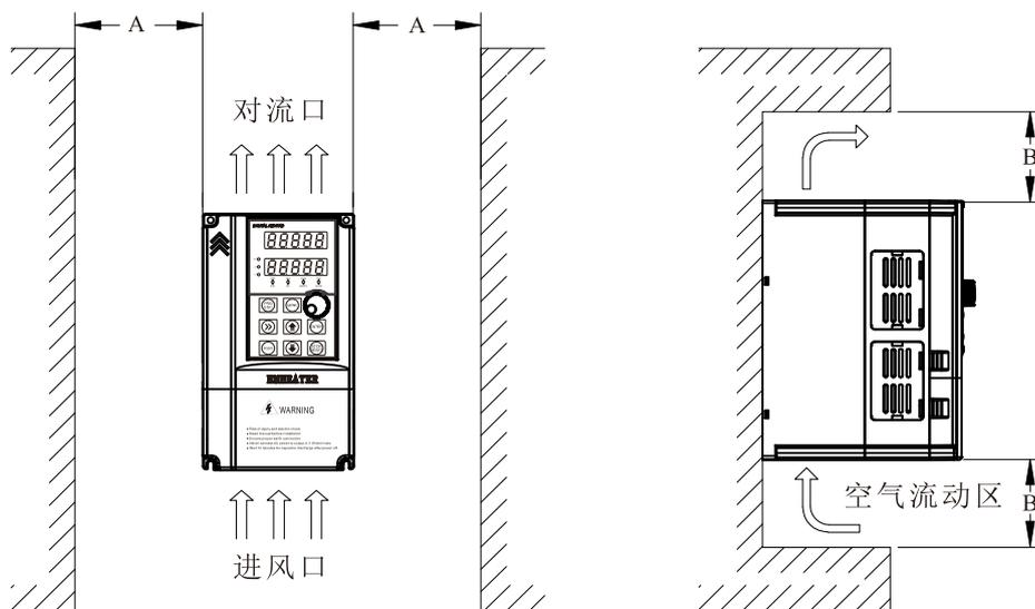
图 3-1 变频器安装风道间隔示意图
