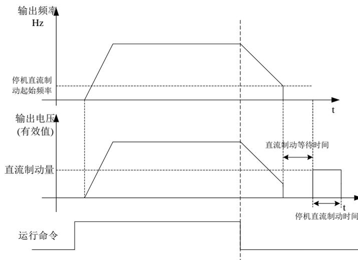
图 5-5 停机直流制动示意图
