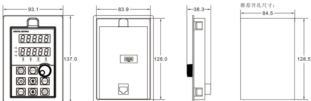
图 2-5 大规格外引键盘（键盘托）的外形尺寸(单位：mm)
