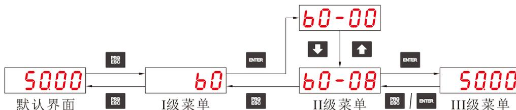
图 4-2 三级菜单操作流程图
