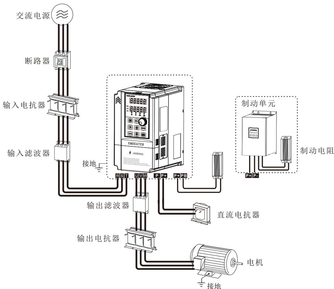
图 3-2 变频器外围设备连接图
