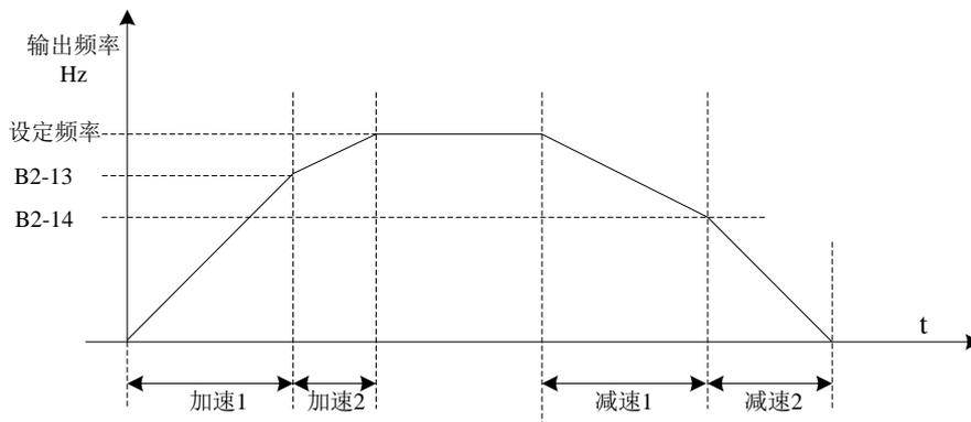
图 5-8 加减速时间切换示意图
