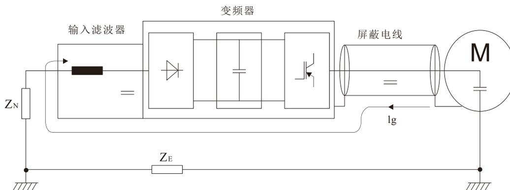
图 3-9 防传导辐射干扰接线示意图
