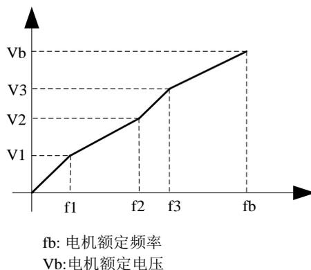
图 5-31 多点 V/F 曲线设定示意图
