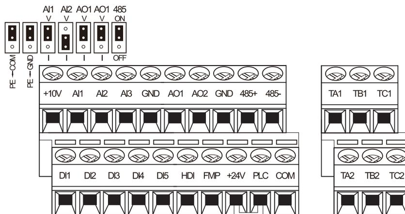
图 3-12 EM15 三相 4kW 以上控制回路端子图
