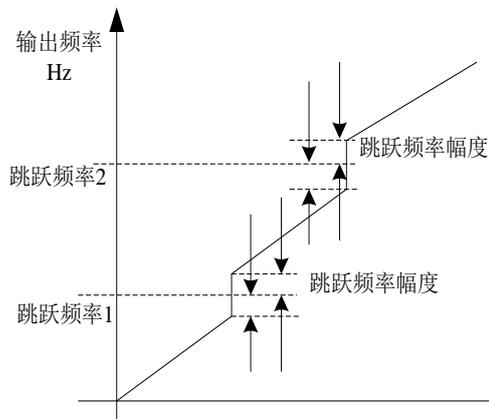
图 5-7 加减速过程中跳跃频率有效示意图
