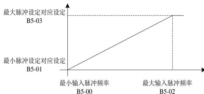
图 5-20 脉冲输入和设定值对应关系
