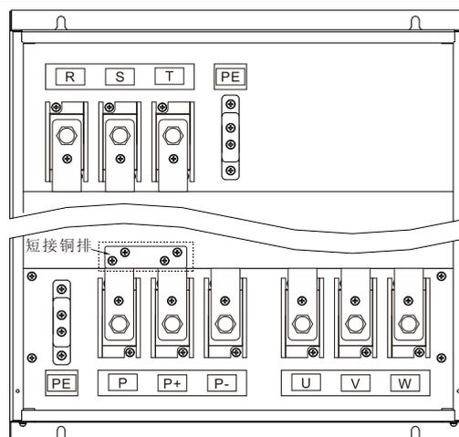
注意: P和P+外接直流电抗器时, 需拆除内部短接铜排
