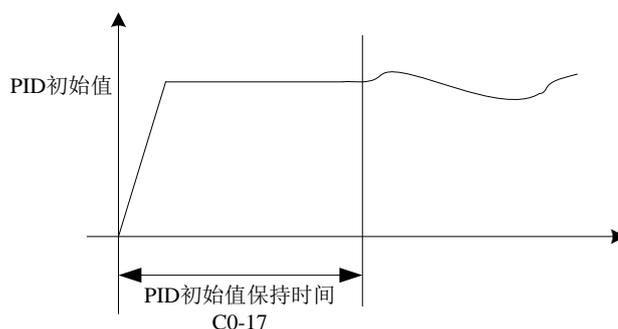
图 5-27 PID 初值功能示意图
